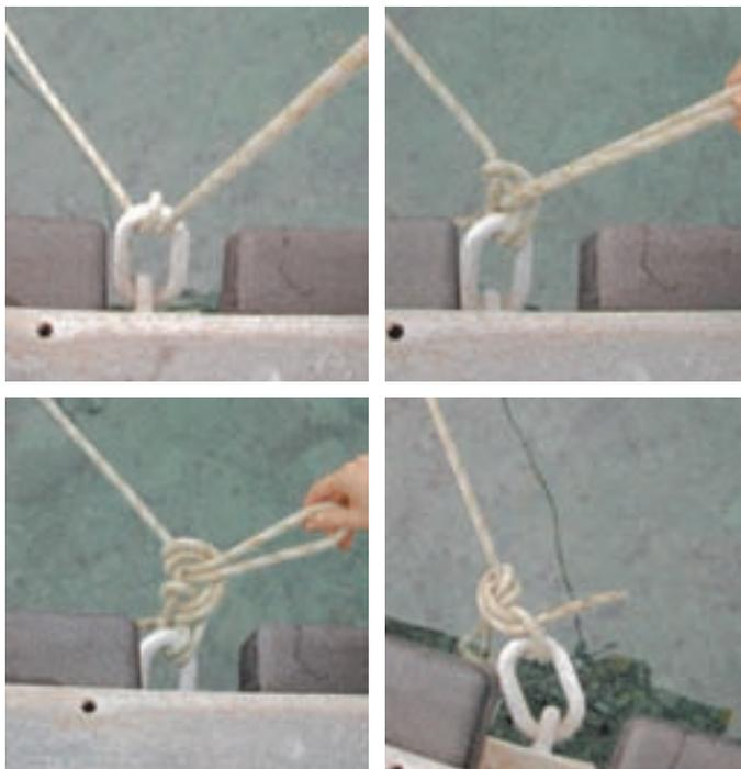
**Dare volta su un anello** Fare prima due volte sull'anello e poi due mezzi colli con la cima a doppino sul dormiente.
